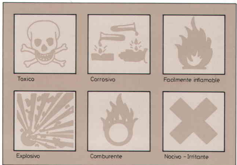
Figura 66. Señalización de agentes químicos peligrosos
